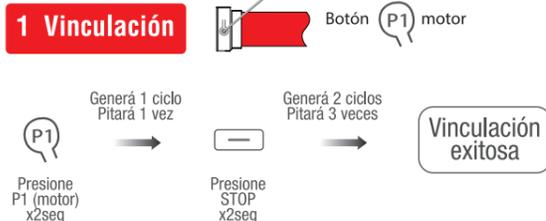
Si dentro de 10 segundos, el motor no recibe la señal de STOP de cualquier emisor, saldrá del modo de emparejamiento automáticamente.
