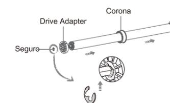
Paso 3 Monte la corona y el drive adapter de manera correcta en el motor. Asegúrese que el drive adapter encaje firmemente y que la corona gire libremente.
