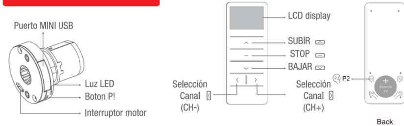
\*Interruptor del motor, 0 motor apagado, 1 motor encendido.
