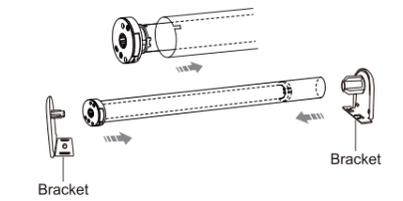
Paso 4 Aline las guías de la corona y del drive adapter con las del tubo de enrollle.
